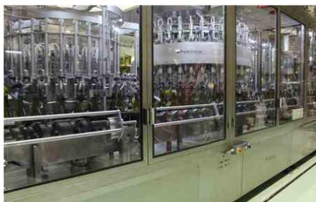
*La rinceuse, tireuse, boucheuse, capsuleuse de dernière génération. Le rendement sur la chaîne est de 8 000 bouteilles par heure. Photo JSL /Nathalie MAGNIEN*
